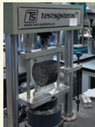
Рис. 1. Схема расчета индекса трещиностойкости ( $CT_{index}$  по ASTM D8225), справа – отечественное оборудование для испытания
