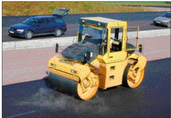
Виброкаток тандемный BW 174AD фирмы Bomag для уплотнения асфальтобетона.
