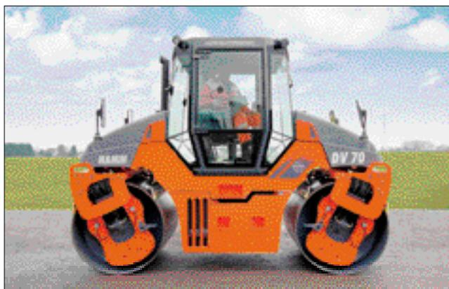
Один из серии тандемных виброкатков DV фирмы Hamm с двойной вибрацией — передний валец с обычными круговыми, а задний — с осцилляторными (вращательными) колебаниями.
