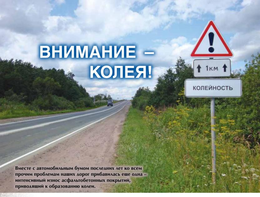
Основными факторами образования колейности на дорогах всегда считали процессы накопления пластических и остаточных деформаций в слоях дорожной одежды и земляного полотна от воздействия движения большегрузных автомобилей. Причиной же еще сравнительно молодого, но не менее угрожающего дефекта, характерного, прежде всего, для крайних левых полос движения в крупных городах и для скоростных автомагистралей северной и
